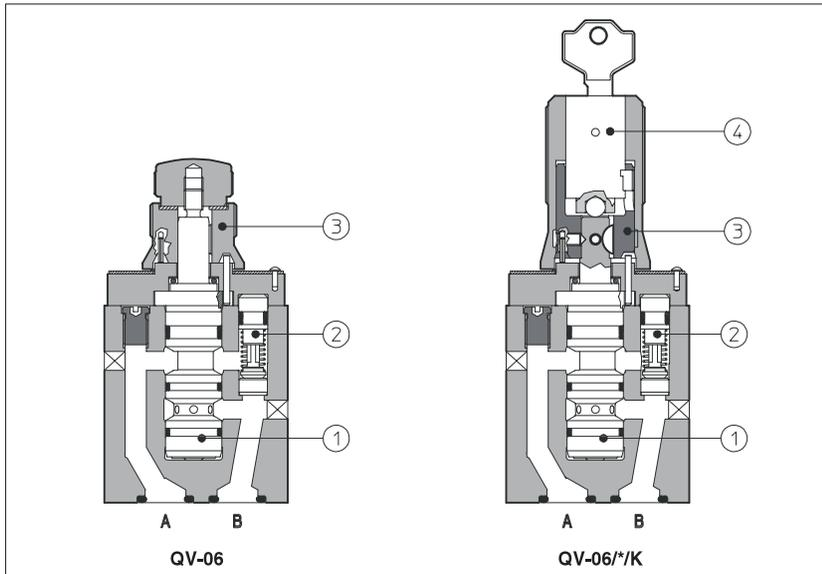
QV是带有压力补偿器①的流量控制阀，即流量与压力变化无关。
